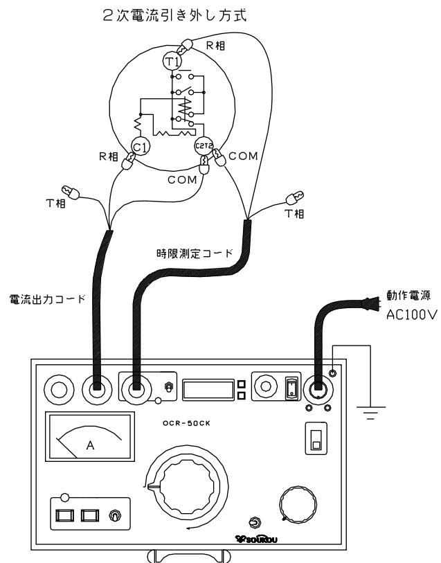
図6：試験回路図—R相単体試験（2次電流引き出し方式）
