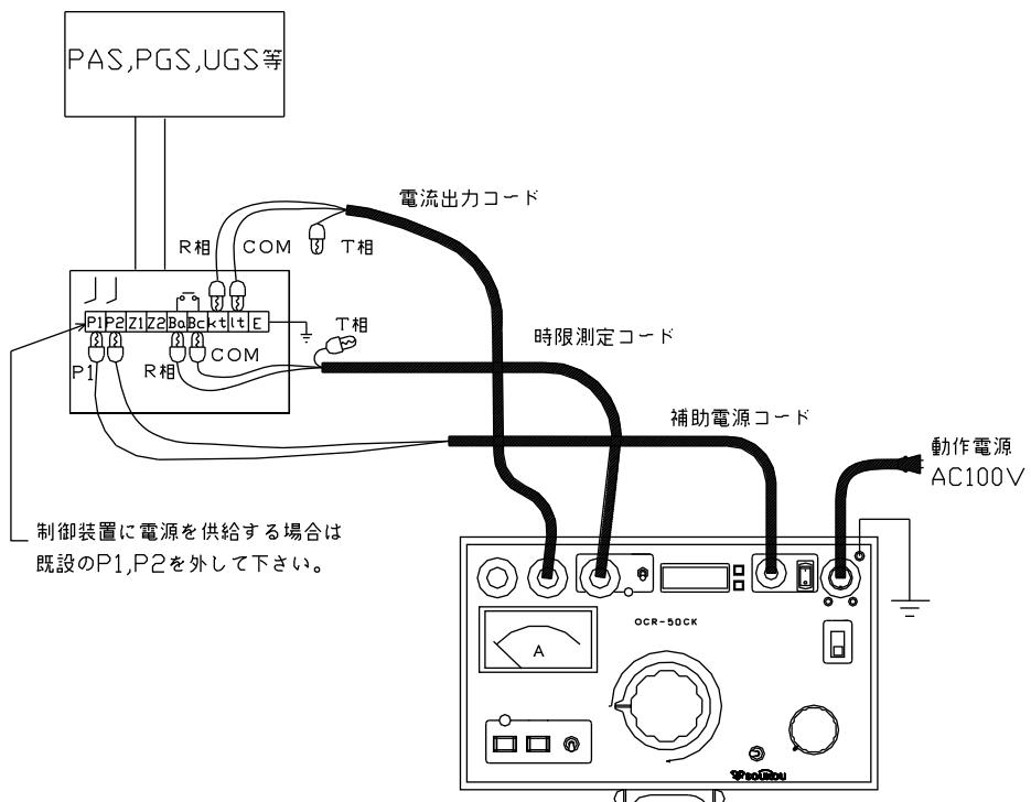
図15：試験回路図一PAS,PGS等の単体試験（停電状態）
