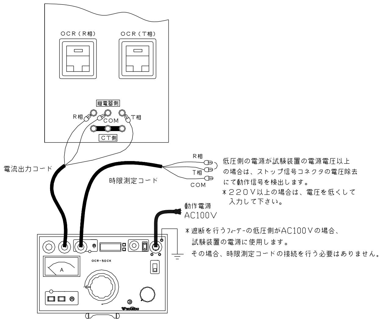
図9：試験回路図一連動試験（受電状態）
