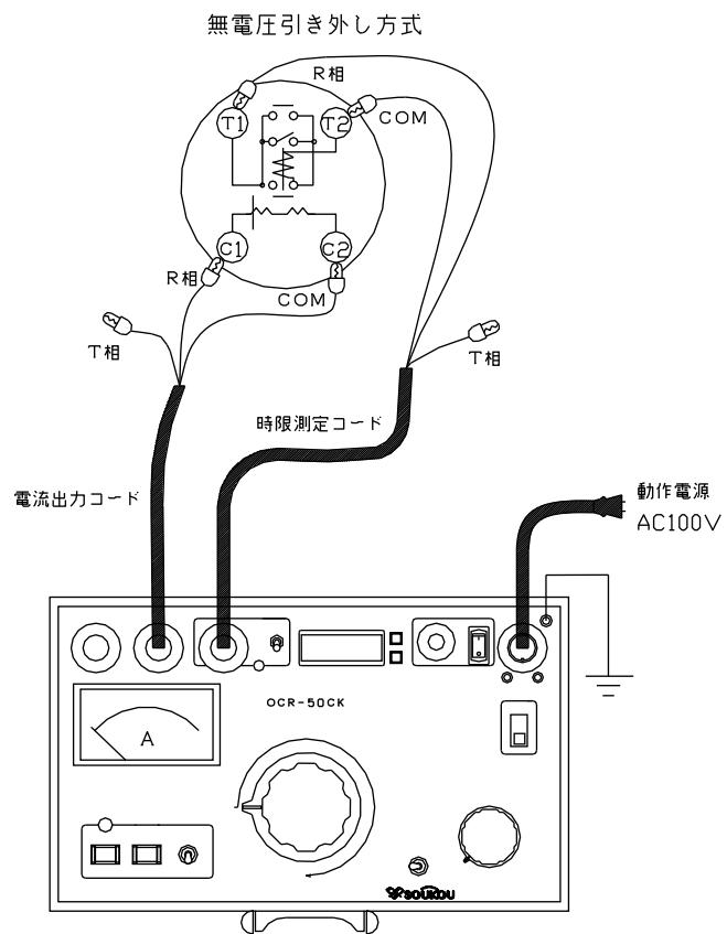
図7：試験回路図ーR相単体試験（無電圧引き出し方式）
