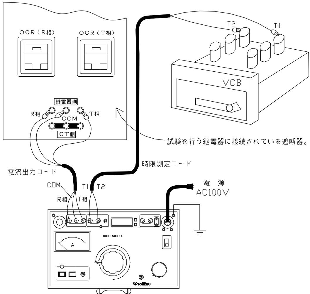
図8：試験回路図一連動試験（停電状態）
