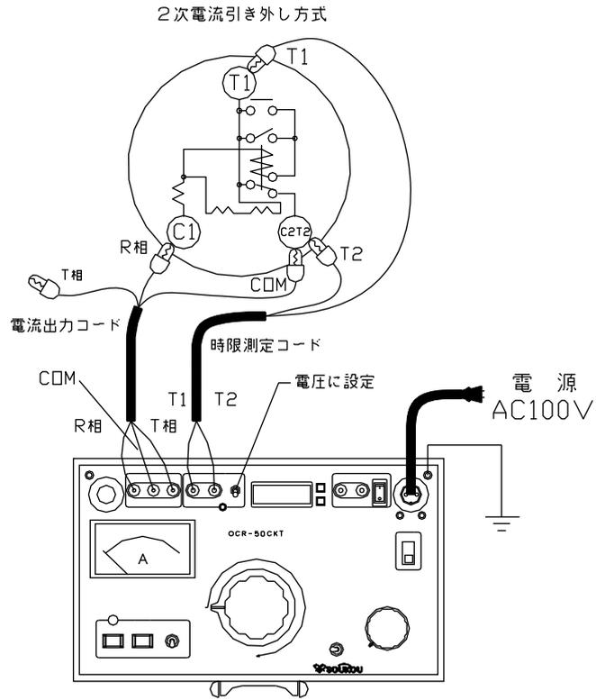
図6：試験回路図－R相単体試験（2次電流引き外し方式）
