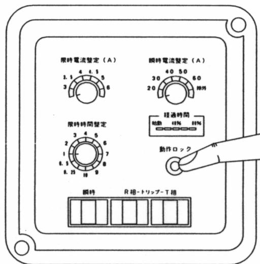
時限要素をロックする場合は、このような動作ロックスイッチを押し動作しないようにします。継電器の機種によって、瞬時要素と同時に停止するタイプと、限時要素のみ停止するタイプがあります。
