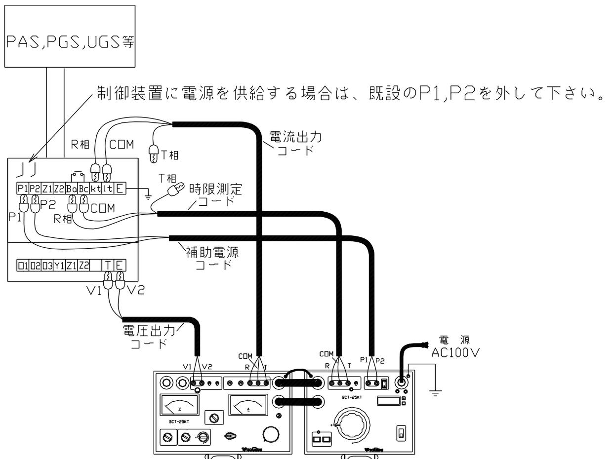
図17：試験回路図一柱上の単体試験（停電状態）
