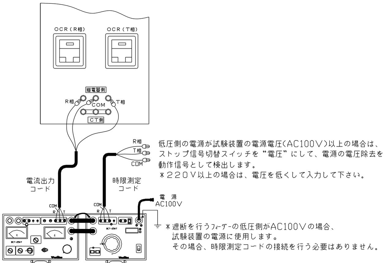
図9：試験回路図一連動試験（受電状態）
