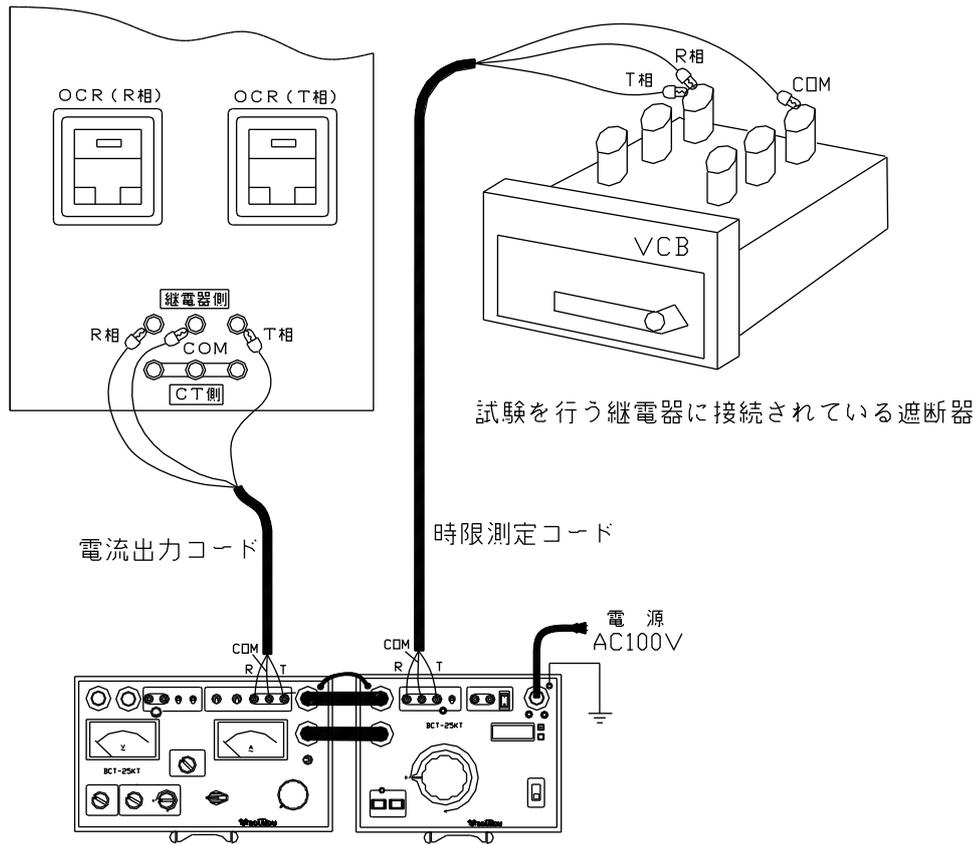
図8：試験回路図一連動試験（停電状態）
