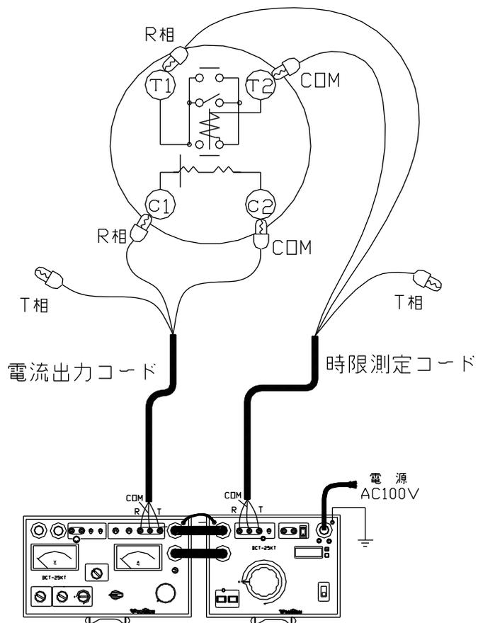
図7：試験回路図一R相単体試験（無電圧引き外し方式）
