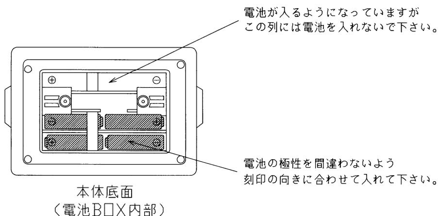
図5：電池の挿入
